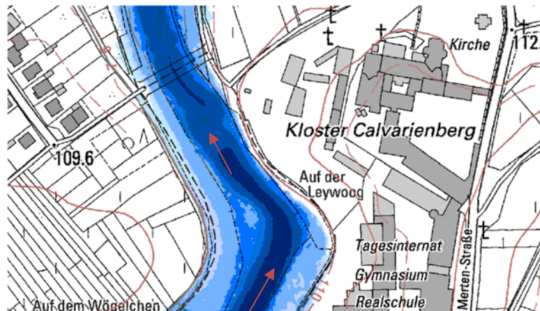
Abb. 7: Höchstes Geländeniveau im Überflutungsbereich von HQ 100 der Ahr anliegend zur Baumaßnahme
