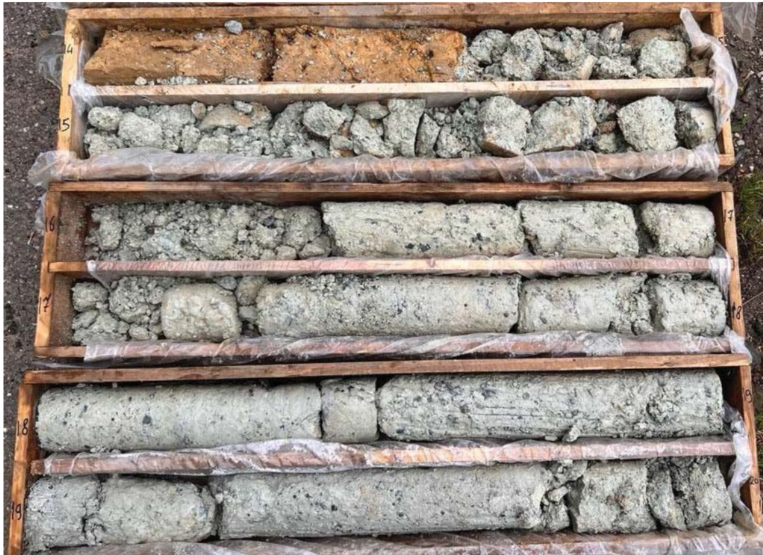
Abb. 3: Kernkisten mit Bohrgut von Kernbohrung KB 3 (14,0 – 20,0 m)
