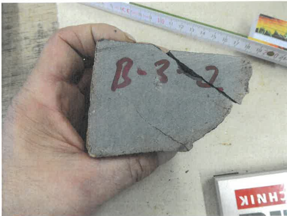
Bild 11: Punktlastversuch, Handstück B-3-2 (ungültiges Bruchbild)
