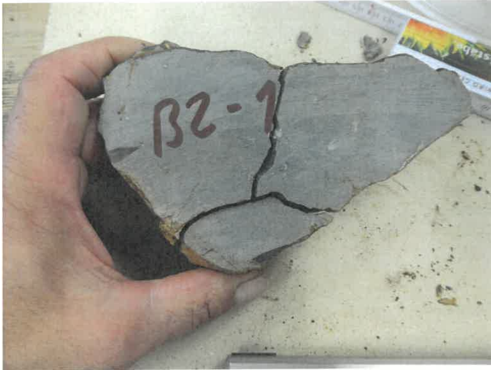
Bild 9: Punktlastversuch, Handstück B-2-2
