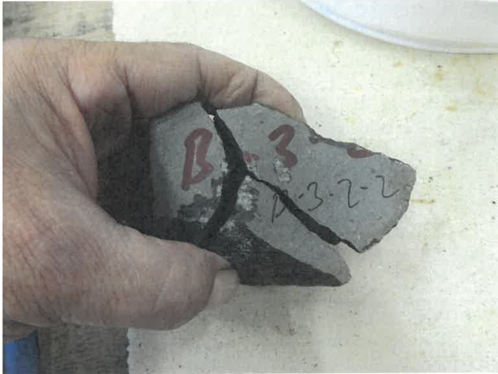
Bild 12: Punktlastversuch, Handstück B-3-2-2
