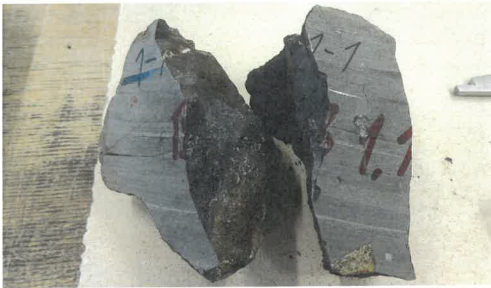
Bild 7: Punktlastversuch, Handstück B-1-2 (ungültiges Bruchbild) und B-1-2-1 (vor der Punktbelastung)
