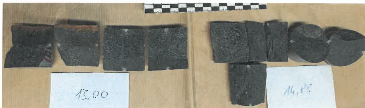
Bild 5: Punktlastversuch, Bohrkerne
