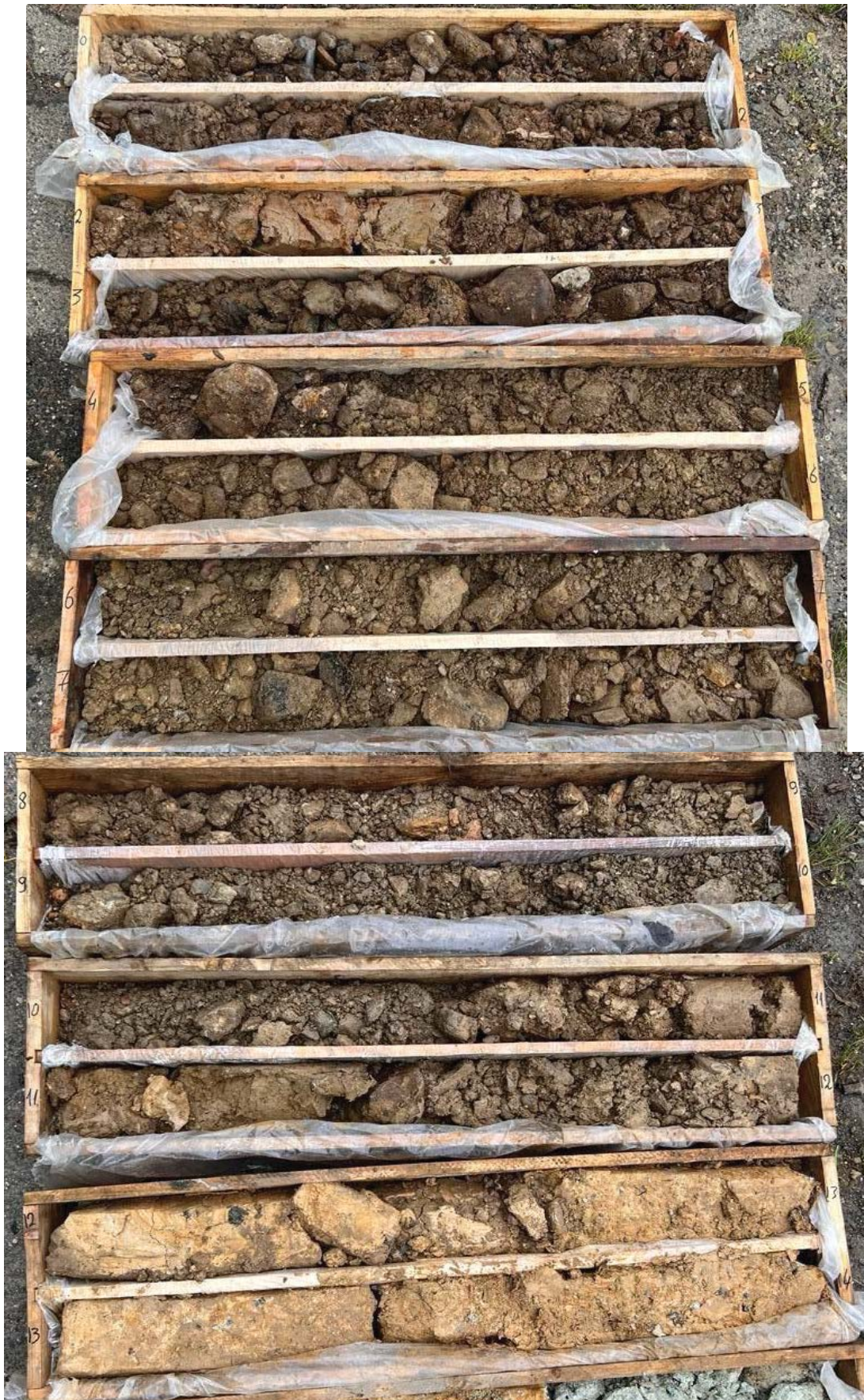
Abb. 1 bis 2: Kernkisten mit Bohrgut von Kernbohrung KB 3 (0 – 14,0 m)
