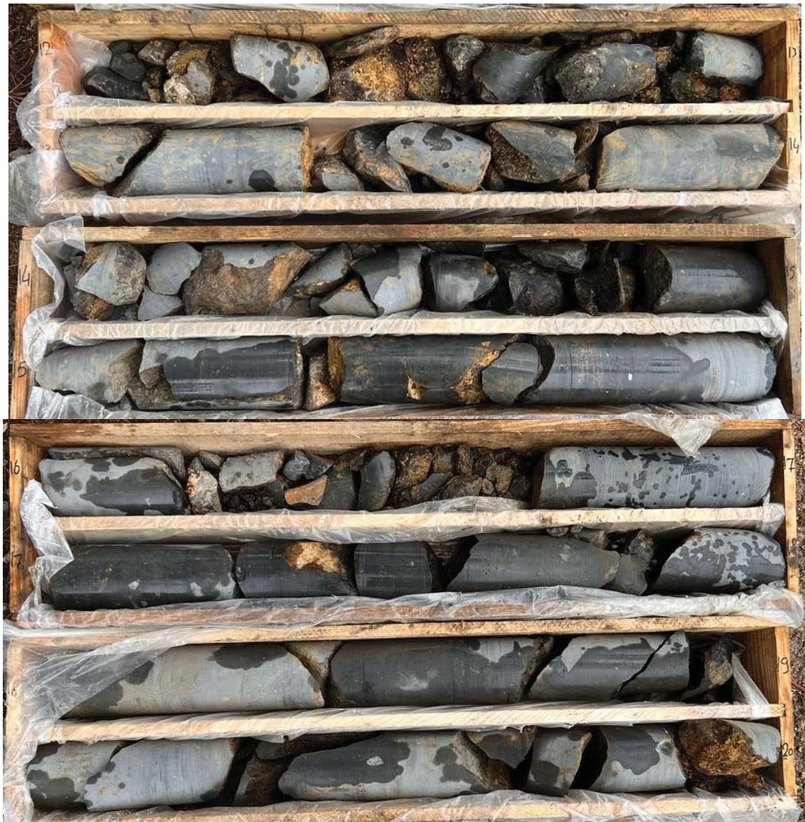
Abb. 7 bis 8: Kernkisten mit Bohrgut von Kernbohrung KB 7 (12,0 – 20,0 m)
