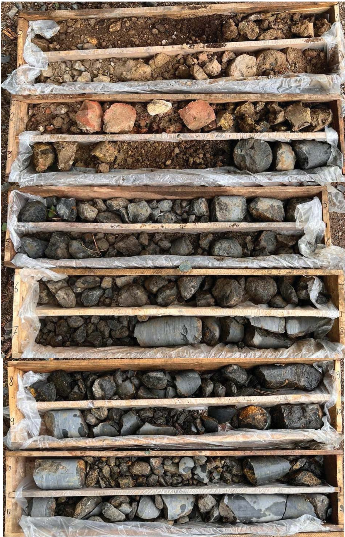
Abb. 4 bis 6: Kernkisten mit Bohrgut von Kernbohrung KB 7 (0 – 12,0 m)
