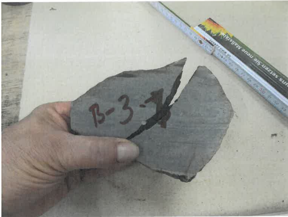
Bild 11: Punktlastversuch, Handstück B-3-2 (ungültiges Bruchbild)
