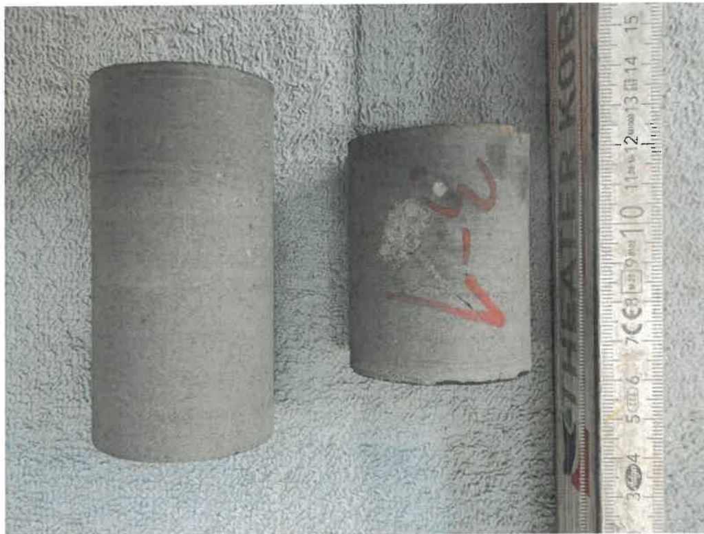
Bild 2: Prüfkörper, einaxiale Druckfestigkeit Links: KB7 13,0-13,3m – Rechts: KB7 14,85-15,0m
