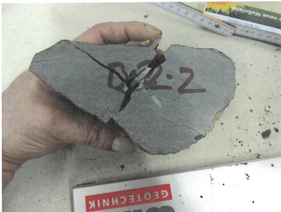
Bild 9: Punktlastversuch, Handstück B-2-2
