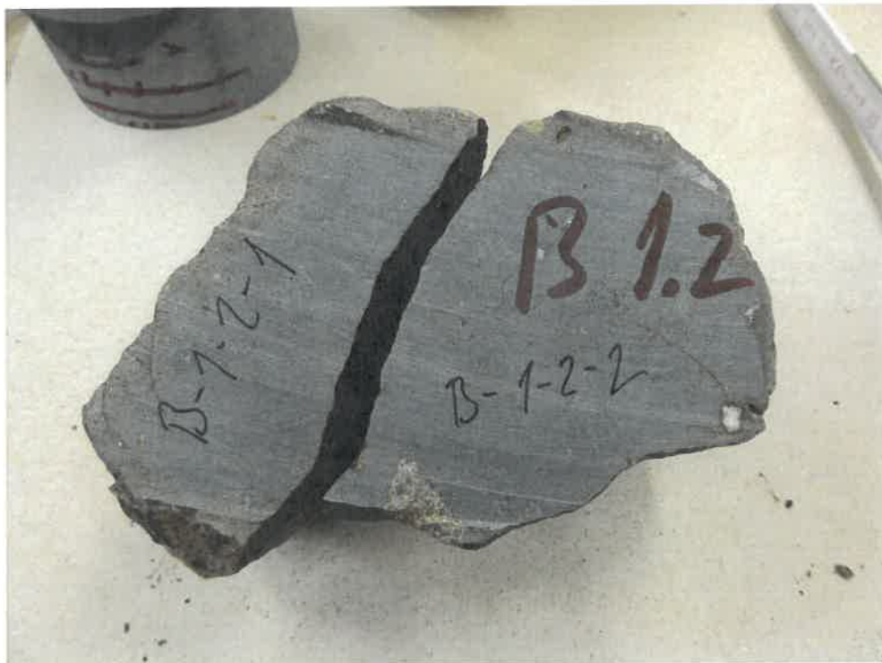
Bild 7: Punktlastversuch, Handstück B-1-2 (ungültiges Bruchbild) und B-1-2-1 (vor der Punktbelastung)
